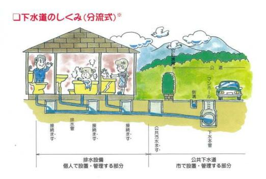
○公共汚水ます・・・お住まいの敷地から出た汚水が最終的に集約されるところで、原則として、道路や側溝の淵から民地側1メートル以内に、1宅地につき1個設置されています。中央に下野市章(もしくは旧町章)が入っています。
